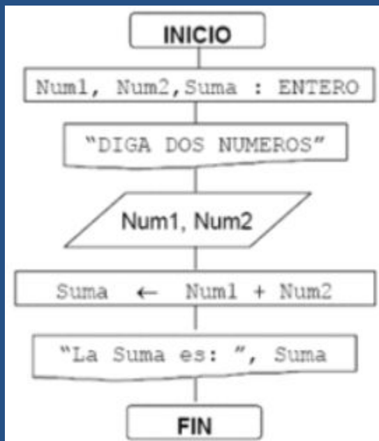
Figura 2.1: Diagrama de flujo de una suma.
