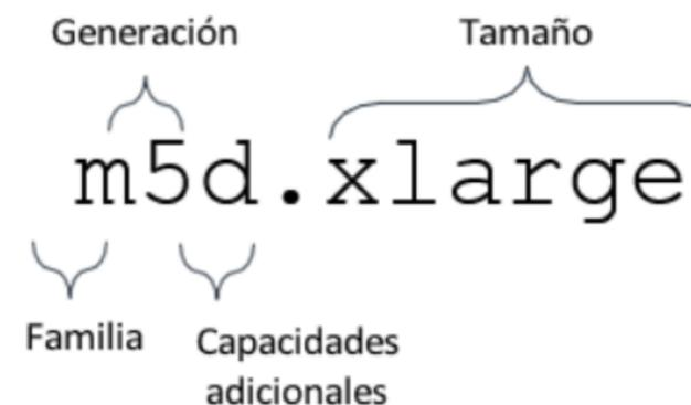
Para poder lanzar una instancia, debe seleccionar el tipo de instancia que quiere usar. Un tipo de instancia EC2 define una configuración de características de rendimiento de CPU, memoria, almacenamiento y red. Con esta configuración se obtiene un nivel de rendimiento informático dado. El tipo de instancia que elija dependerá de los requisitos de rendimiento y costo de la carga de trabajo.
